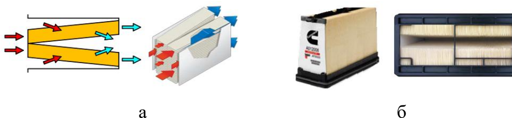
Рис. 4.11. Принцип роботи панельної фільтрувальної вставки Direct Flow: а - схема руху повітряного потоку; б - конструкція вставки.
