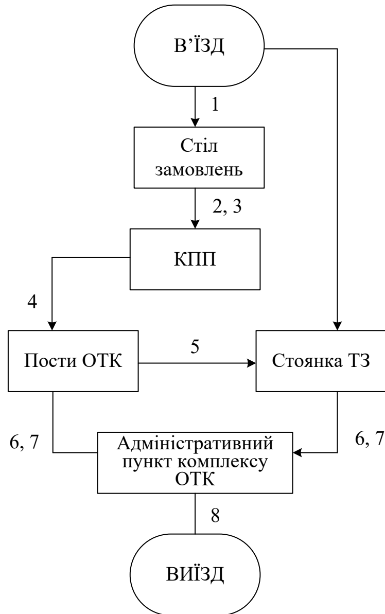
Рис. 2.2. Схема організації технологічного процесу обов'язкового технічного контролю автомобілів у пункті з визначення їх технічного стану.
