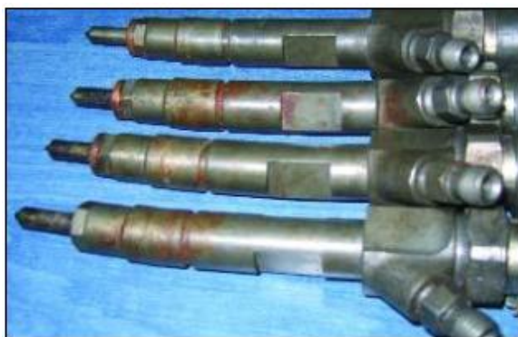
Рис. 2.4. Погнуті під час демонтажу корпуси форсунок.
