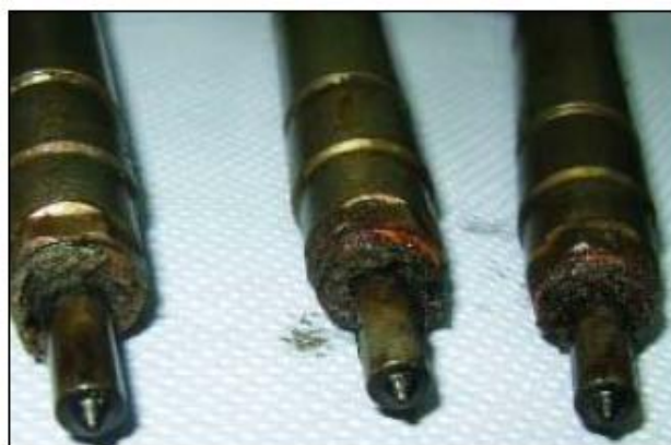
Рис. 2.5. Наслідки неправильного встановлення форсунок.
