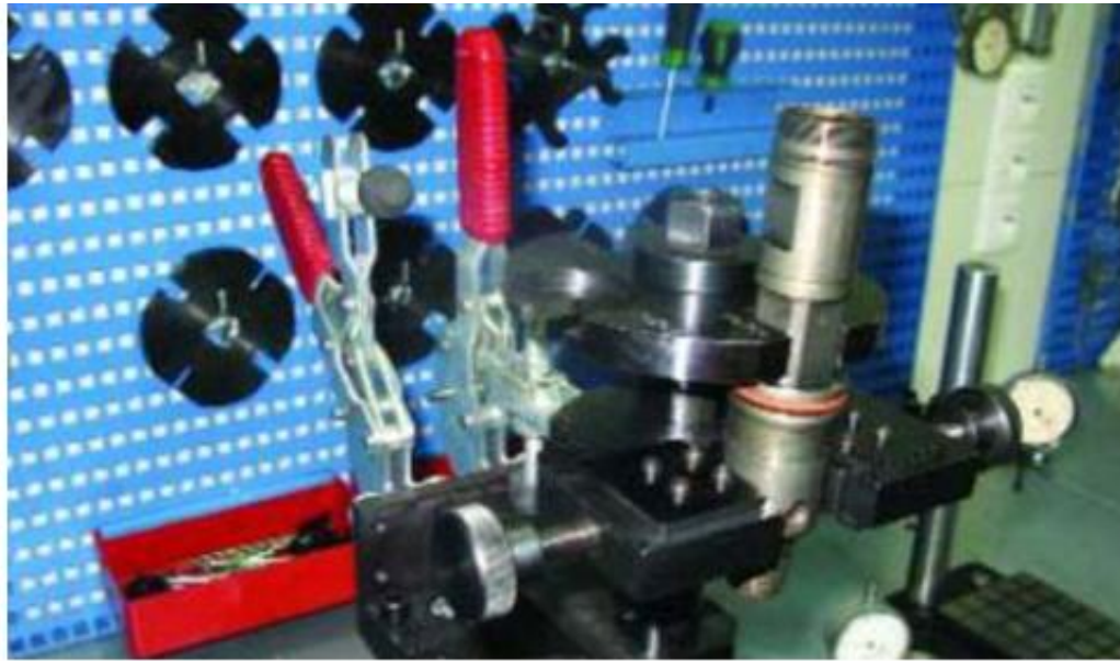
Рис. 2.43. Збирання форсунки починають з сторони електромагніту.
