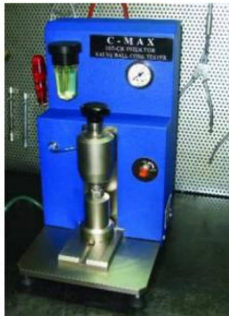
Рис. 2.22. Пневматичний тестер для контролю стану сідла клапана мультиплікатора.
