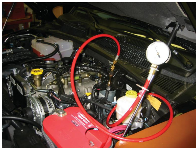
Рис. 2.1. Манометр, під'єднаний для контролю тиску палива, що подається підкачувальним насосом на дизельному двигуні.
