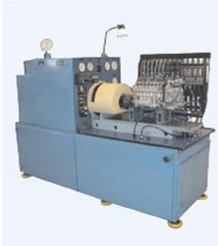
Рис. 3.4. Стенд для діагностики й регулювання ПНВТ мод. ДД-1005.
