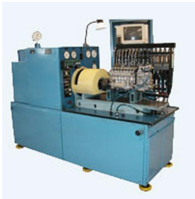
Рис. 3.3. Стенд ДД-1002 для вбудованої перевірки ПНВТ1.
