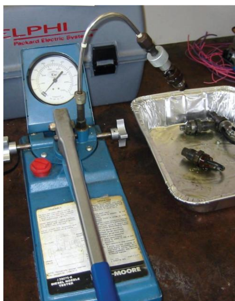
Рис. 2.3. Типовий рор-тестер, призначений для перевірки факела розпилення дизельної форсунки.
