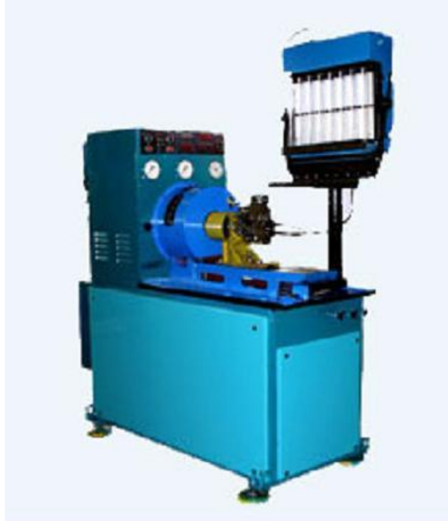
Рис. 3.2. Стенд для діагностики й регулювання ПНВТ мод. ДД-1001.
