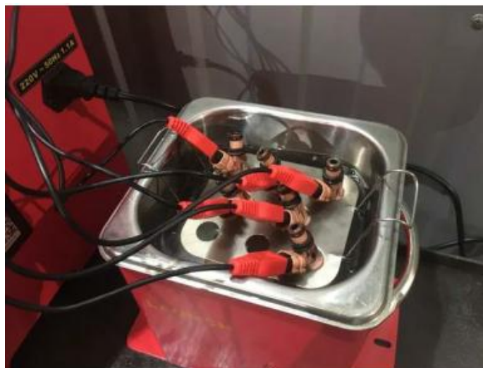
Рис. 4.5. Рис. 2.3 Метод ультразвукової очистки форсунок.
