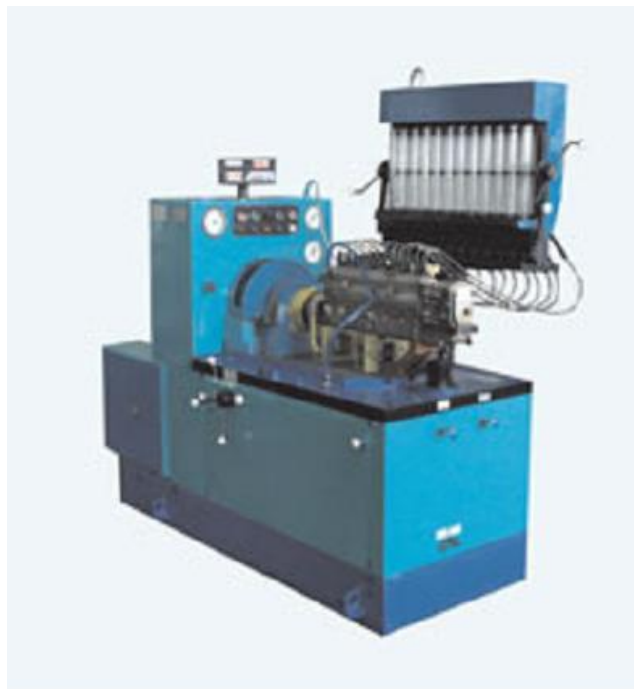
Рис. 3.1. Стенд для діагностики й регулювання ПНВТ мод. ДД-1000.
