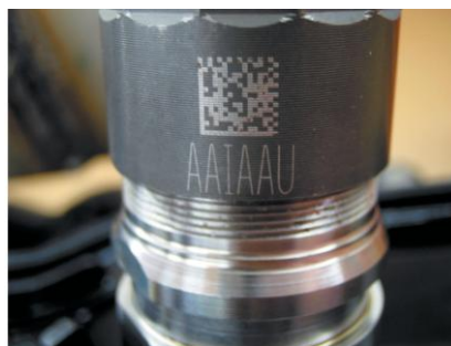
Рис. 2.3. Позначення, нанесені на бічній поверхні форсунки дизельного двигуна Cummins робочим об'ємом 6,7 л, містять її індивідуальний калібрувальний код.
