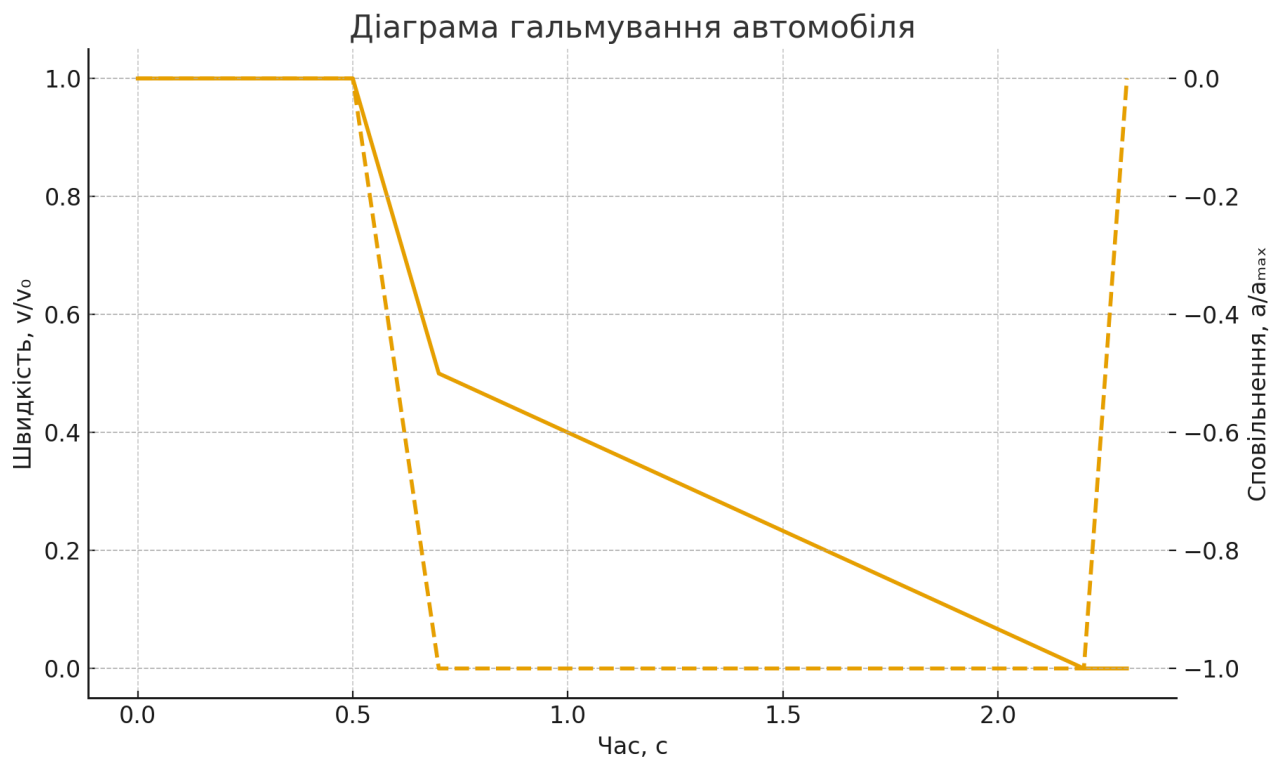
Рис. 4.2. Гальмова діаграма автомобіля.
