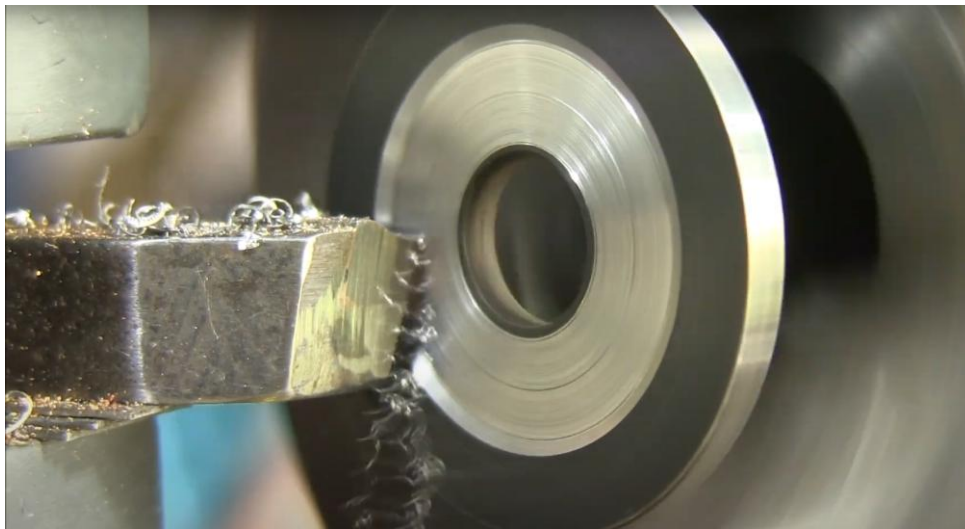
Рис. 2.4. – Зображення процесу проточки.
