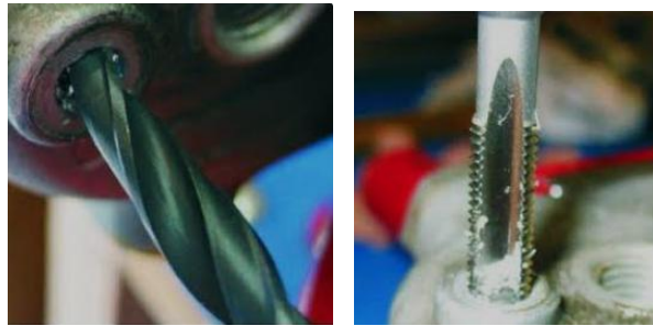
Рис. 2.6. Зображення процесу свердління і нарізання різьби.
