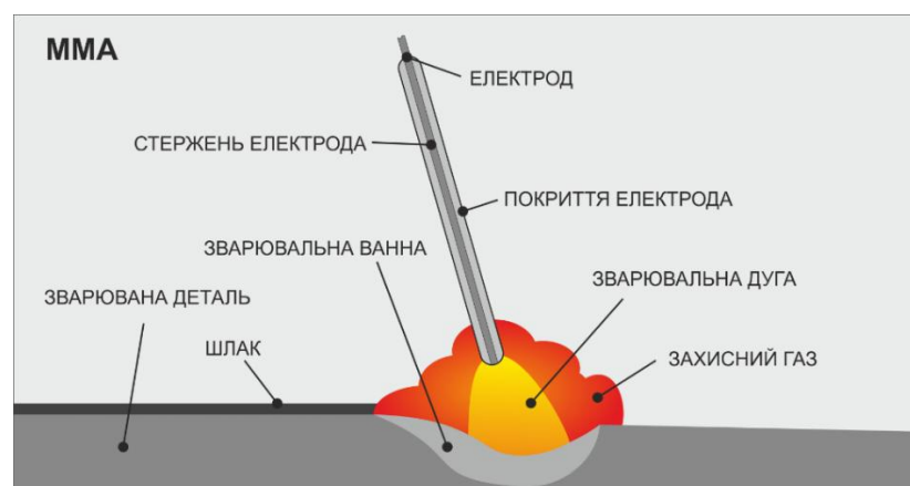
Рис. 2.7. Схема ручного дугового зварювання.
