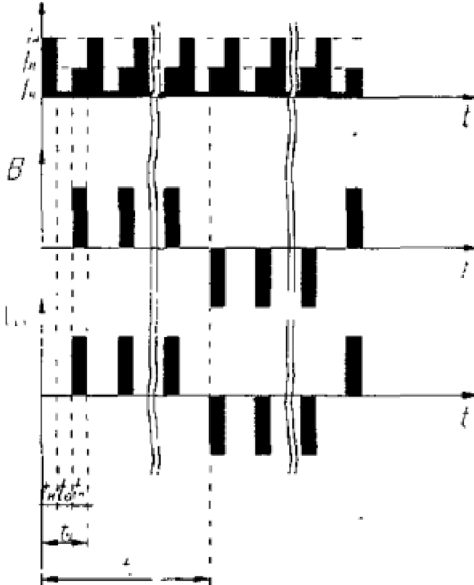
Рис. 1.5. Часові діаграми роботи джерела живлення для наплавлення, індукції керуючого магнітного поля і переміщення дуги.
