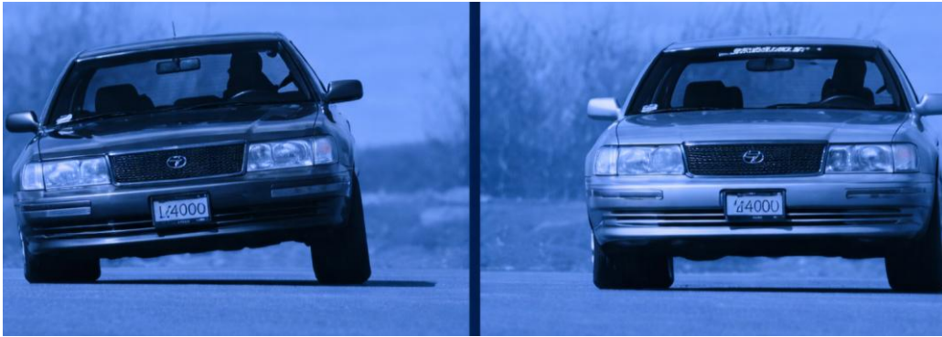
Рис. 4.7. Зниження величини крену кузова автомобіля, система Bose.
