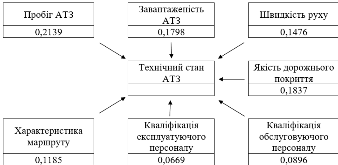
Рис. 4.2. Структура розподілу вагомості експлуатаційних чинників, що визначають вплив умов використання на технічний стан автотransпортних засобів.
