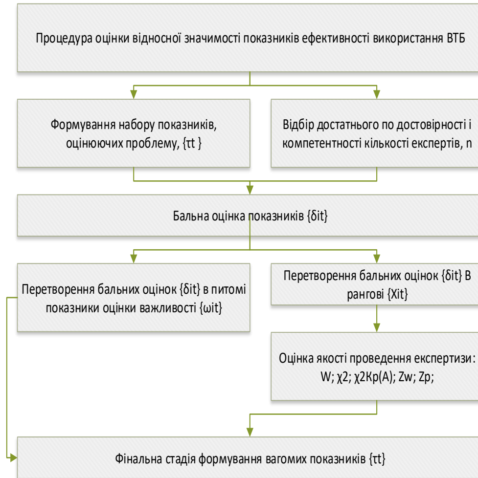
Рис. 4.4. Алгоритм визначення вагових коефіцієнтів показників ефективності використання виробничо-технічної бази автотранспортних підприємств.
