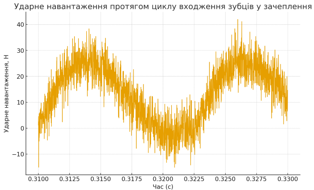
Рис. 4.3. Динаміка зміни ударних навантажень протягом послідовних циклів входження зубців у зачеплення (п'ята передача з розвантаженою шестернею, 20 °С, 10 мкм).
