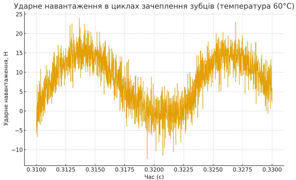
Рис. 4.5. Характер зміни ударного навантаження у послідовних циклах входження зубців у зачеплення (вільна шестерня п'ятої передачі, 60 °С, 10 мкм).
