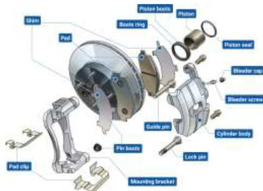
Рис. 1.11. Основні елементи дискової гальмівної системи автомобіля.
