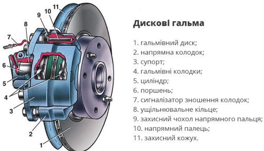
Рис. 2.3. Дисковий гальмівний механізм легкового автомобіля.
