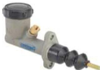
Рис. 1.3. Конструктивне виконання головного гальмівного циліндра.
