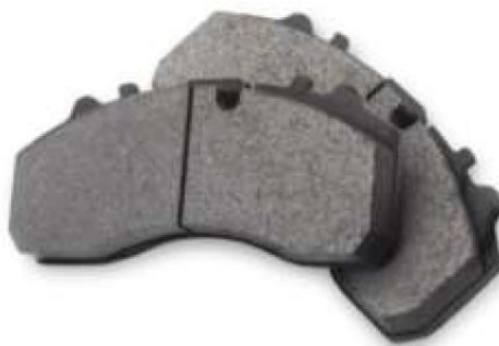
Рис. 1.8. Фрикційні колодки гальмівного механізму.
