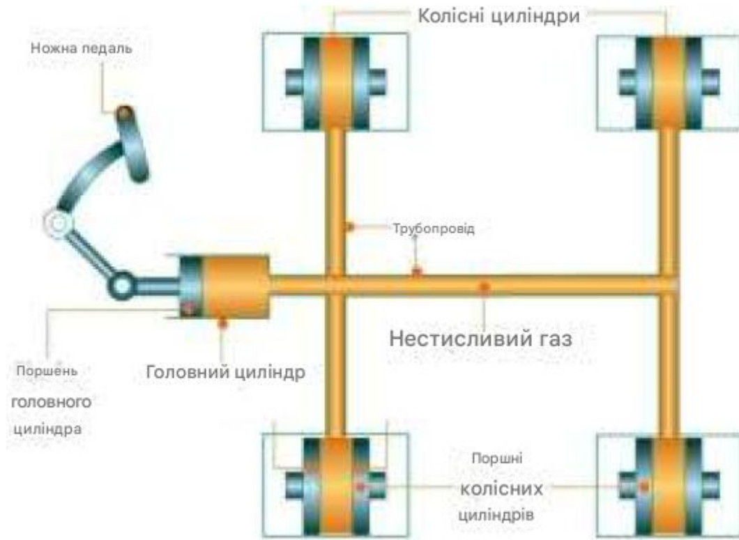
Рис. 1.10. Структурна схема гідравлічного приводу гальм.
