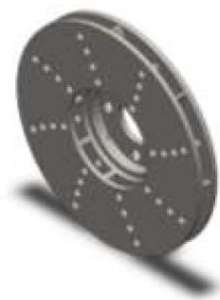
Рис. 4.1. Модель дискового гальма, розроблена для теплового аналізу.
