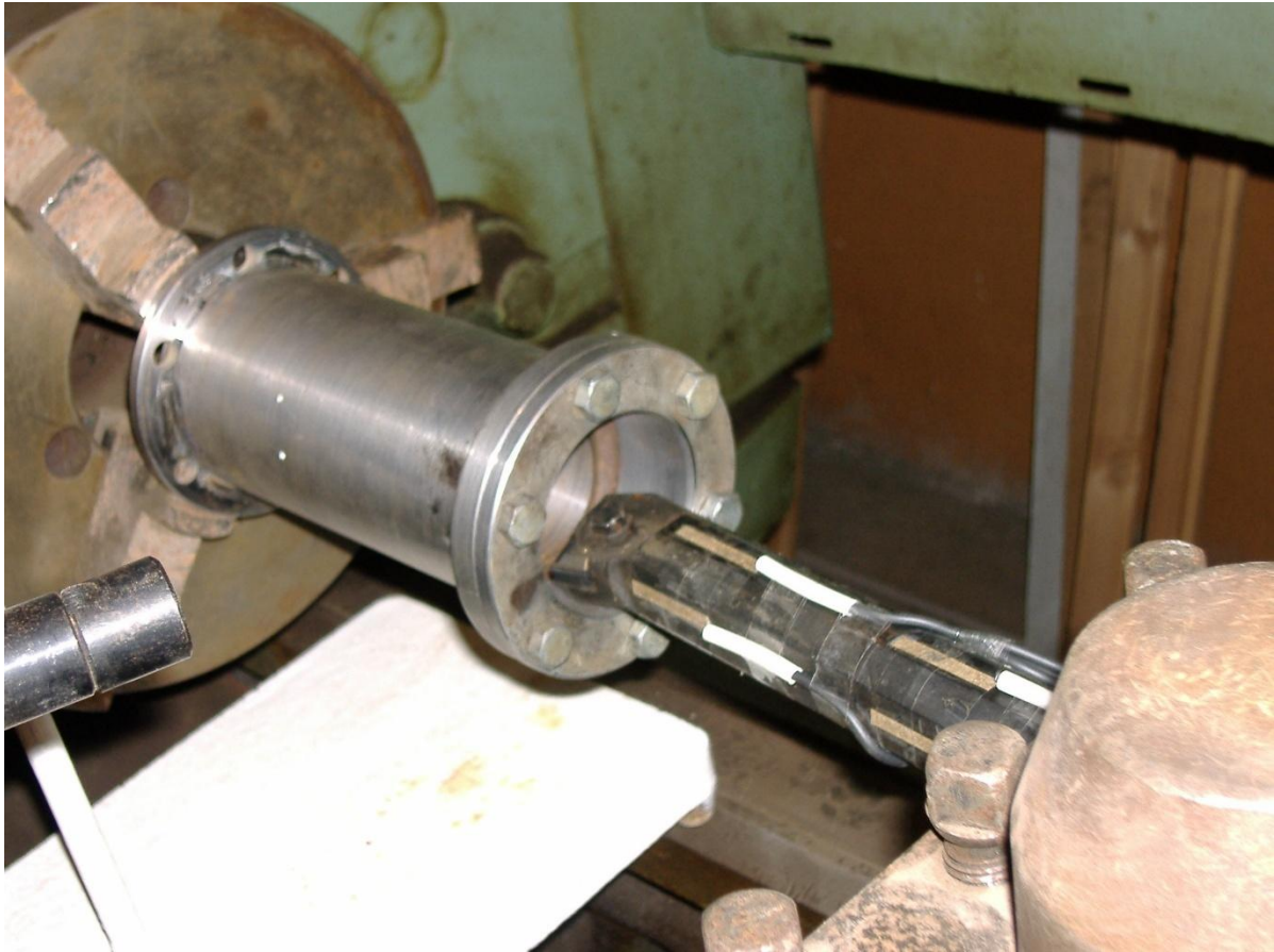
Рис. 4.2. Світлина пристрою для проведення процесу розточування.
