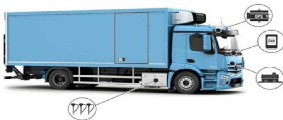
Рисунок 3.3. – Поєднаний метод контролю палива за допомогою GPS [20]
