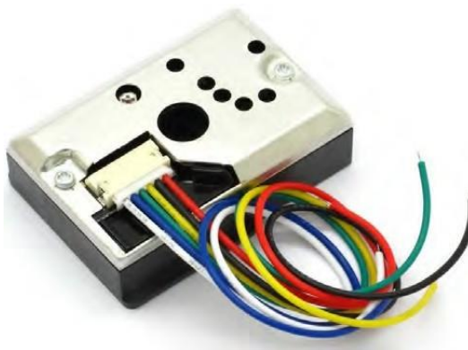
Рисунок 2.6: Оптичний детектор пилю.
