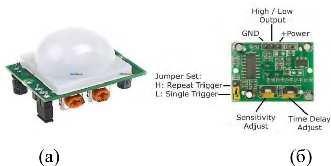
Рисунок 2.5: (а) PIR детектор руху (вид зверху). (b) PIR детектор руху (вид знизу).
