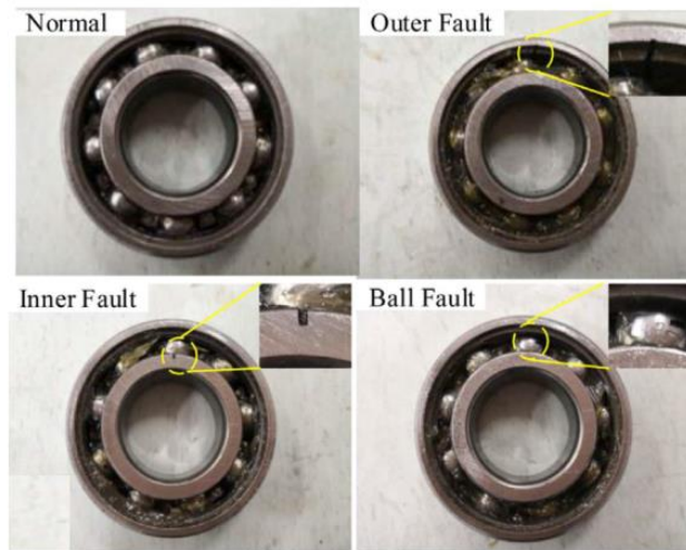
Рисунок 1. Типові дефекти підшипника: нормальний стан, дефект зовнішнього кільця (Outer Fault), дефект внутрішнього кільця (Inner Fault) та дефект тіла кочення (Ball Fault) [4].
