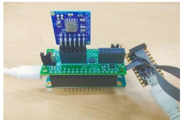
Рисунок 1.12 – Raspberry Pi + цифрові акселерометри (ADXL355, ADXL345)
