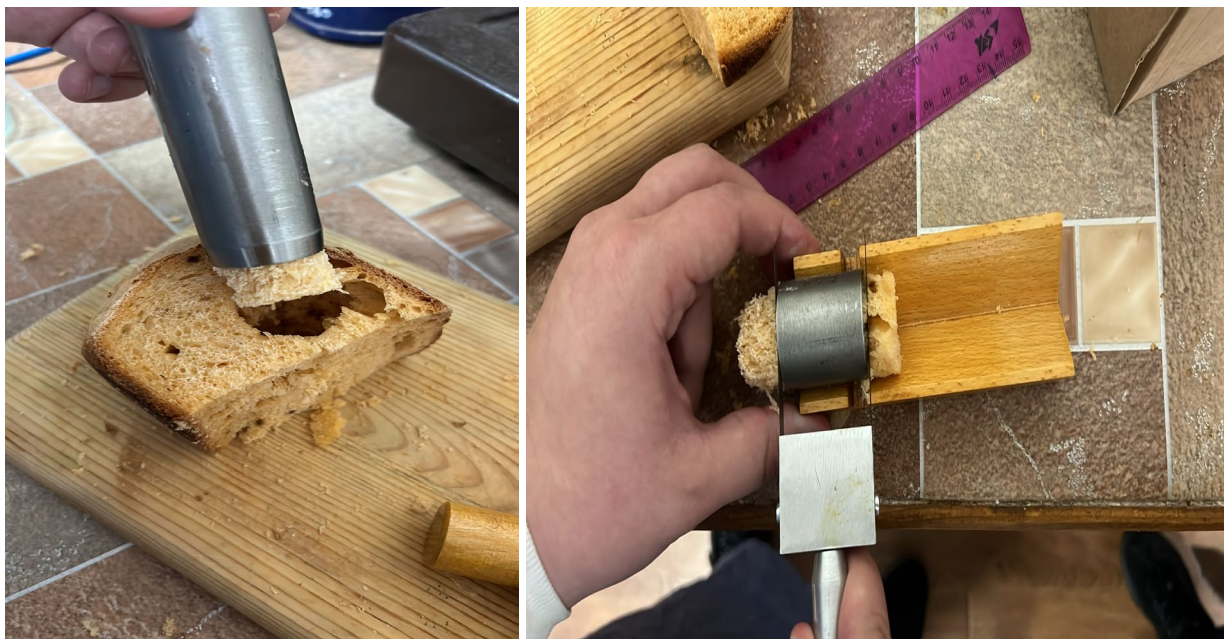
Рис. 1.8. – Дослідження пористості методом відношення об'єму пор до об'єму хлібної м'якушки
