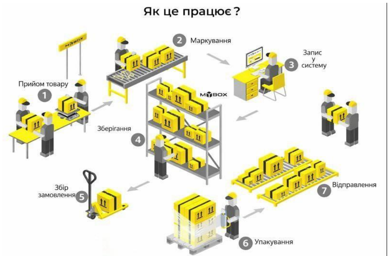
Рисунок 1.3 – Схема роботи Fulfillment Centers (центру виконання замовлень)
