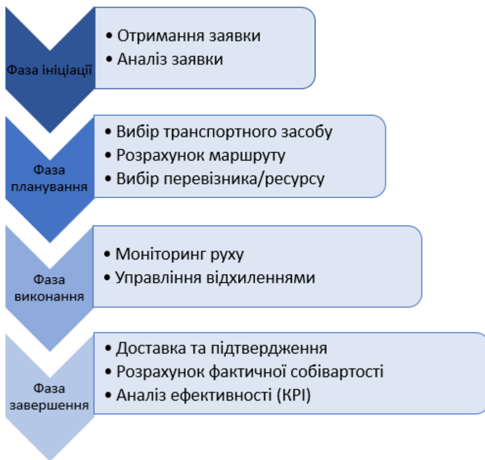
Рисунок 1.8 – Етапи проектування транспортно-технологічного процесу
