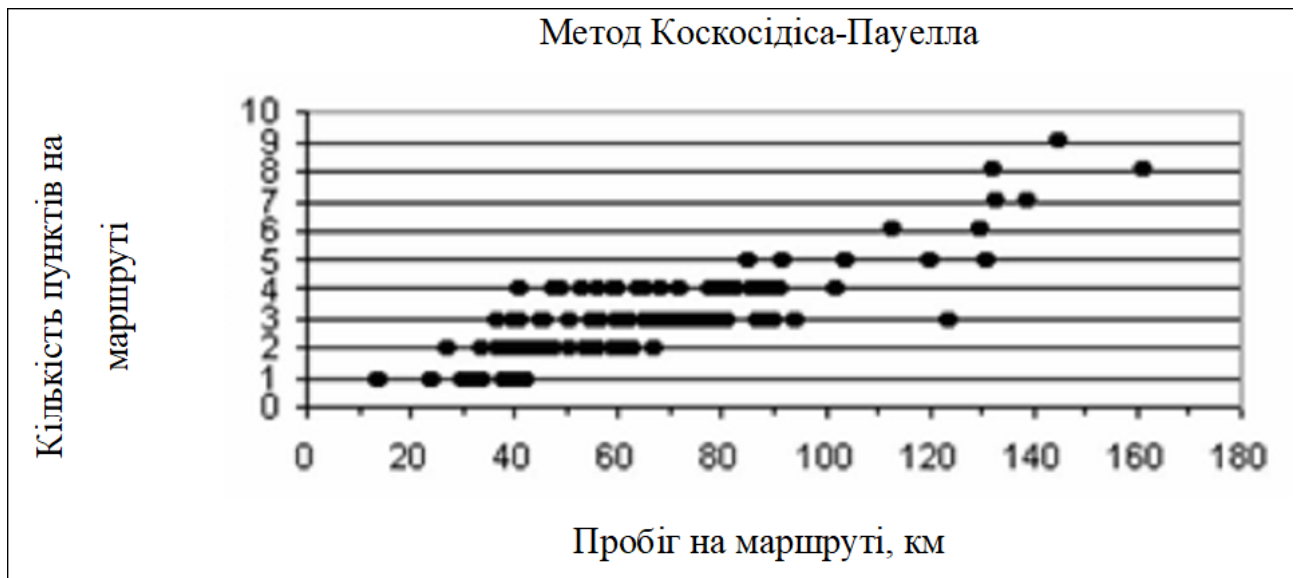
Рисунок 2.4 – Залежність пробігу від кількості пунктів для 195 маршрутів, сформованих за методом Коскосідіса–Пауелла
