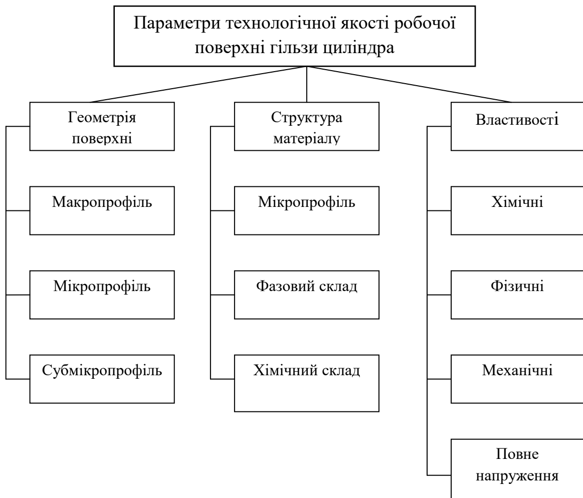
Рисунок 1.3 Параметри технологічної якості робочої поверхні гільзи циліндра
