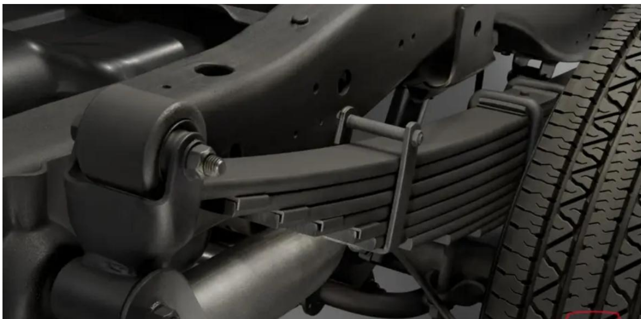
Рисунок 1.1 – Загальний вид ресори встановленій на автомобілі
