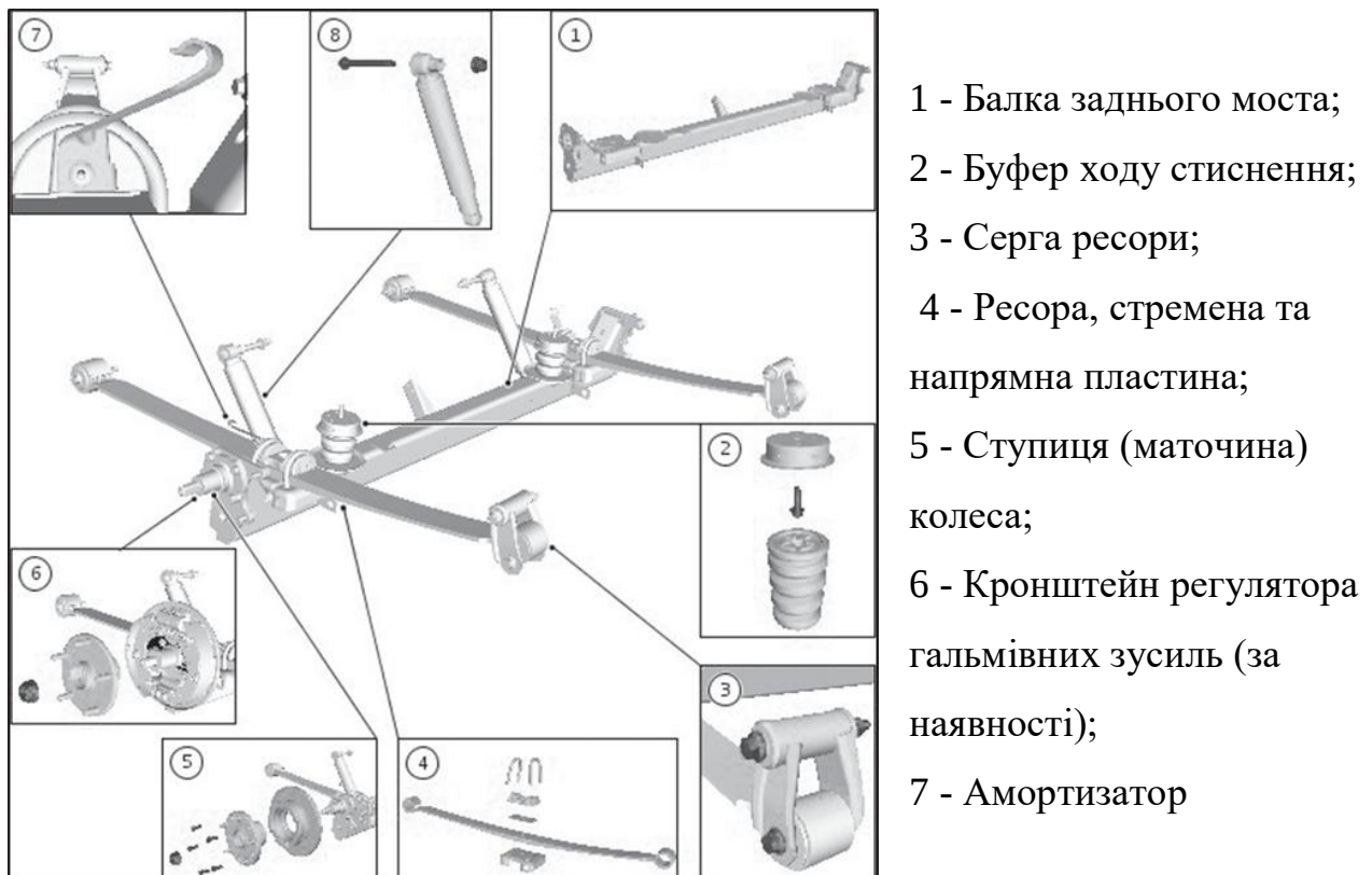
Рисунок 1.3 - Задня підвіска модифікацій Фургон та Мікроавтобус
