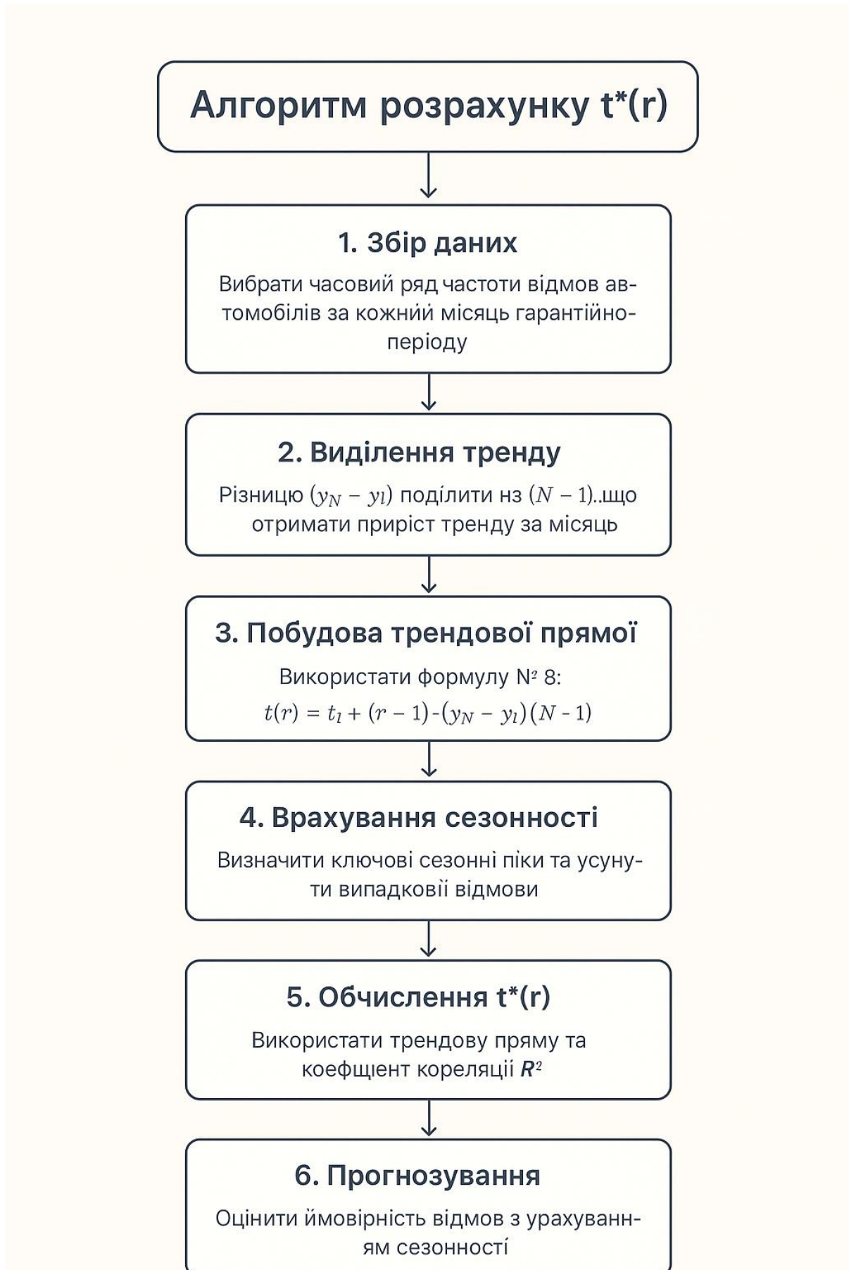
Рисунок 4.3 – Алгоритм для розрахунку тренду частоти відмов t(r) із врахуванням гарантійного періоду та сезонності
