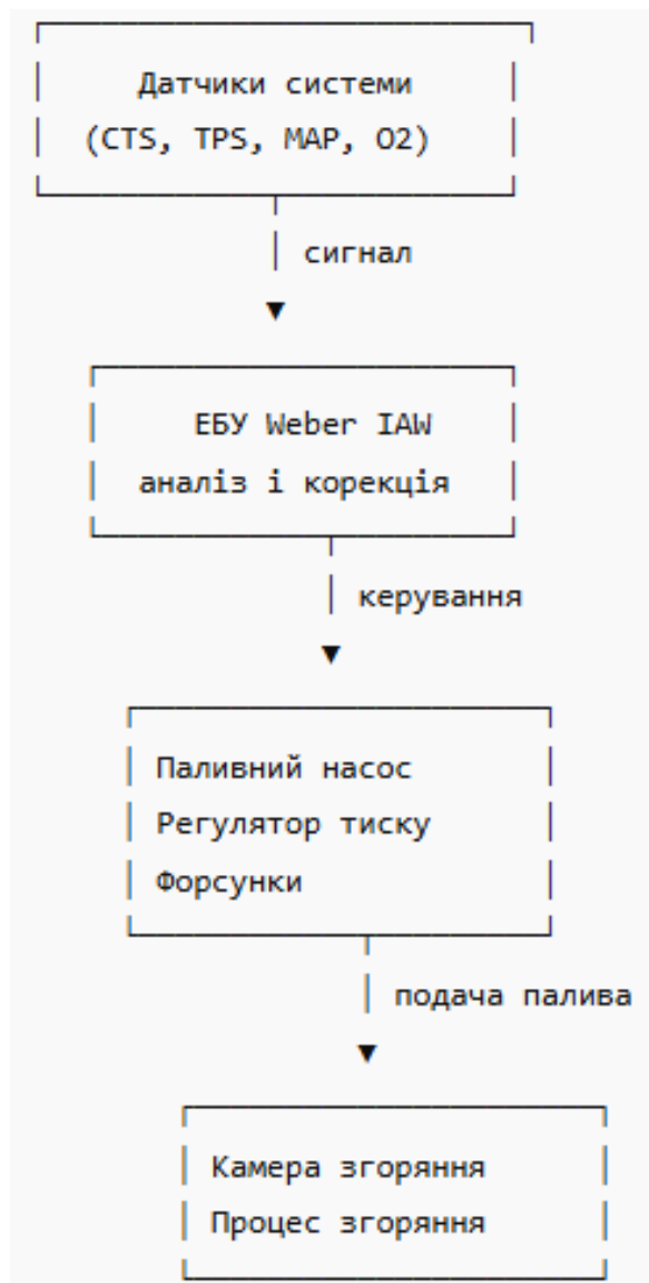
Рисунок 1.1 – Структурна схема впливу параметрів системи Weber IAW на роботу ДВЗ
