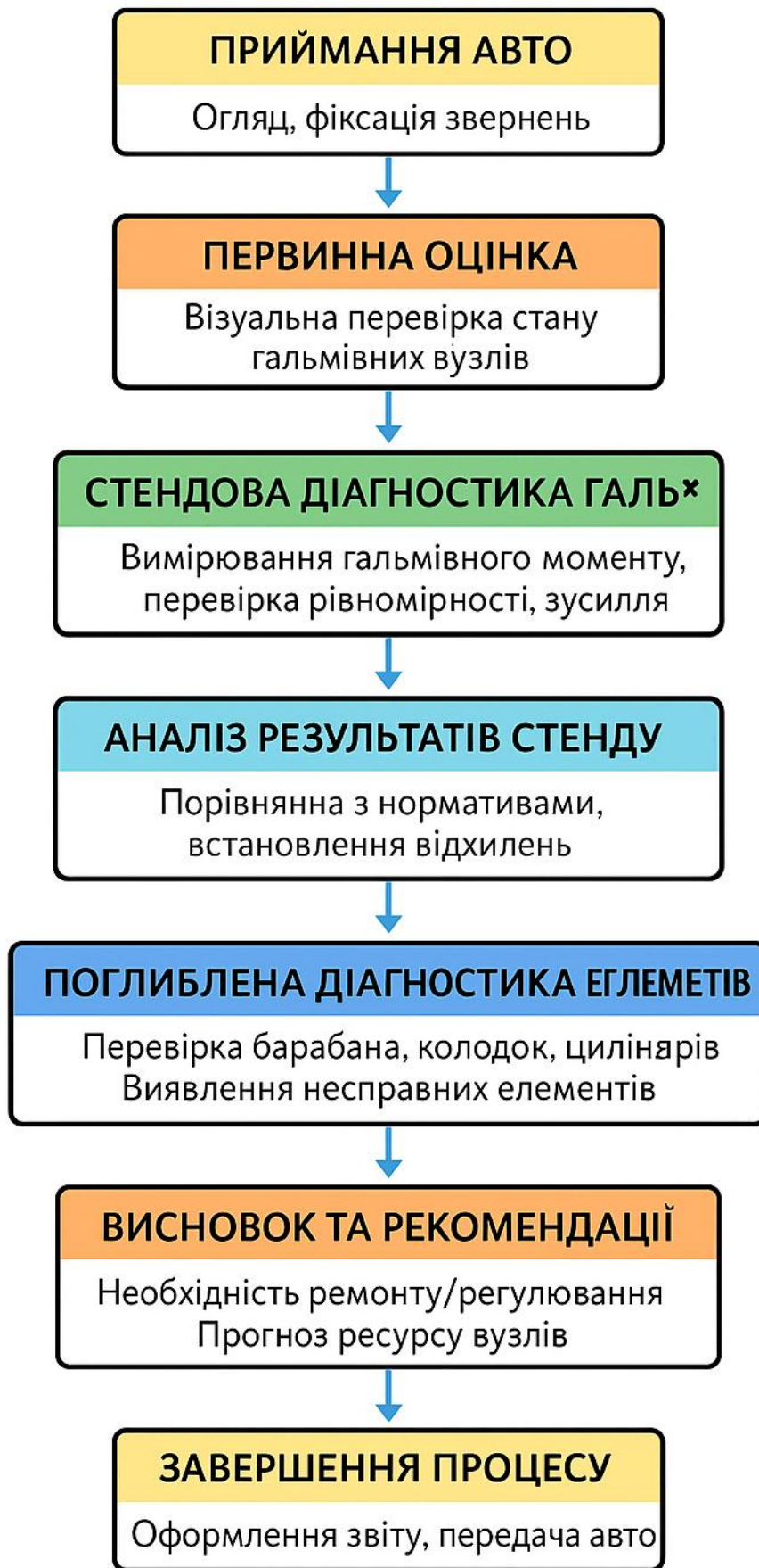
Рисунок 1.3 – Схема діагностики гальм
