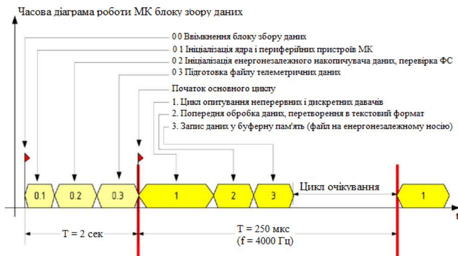
Рисунок 1. Часова діаграма функціонування МК блоку збору даних
