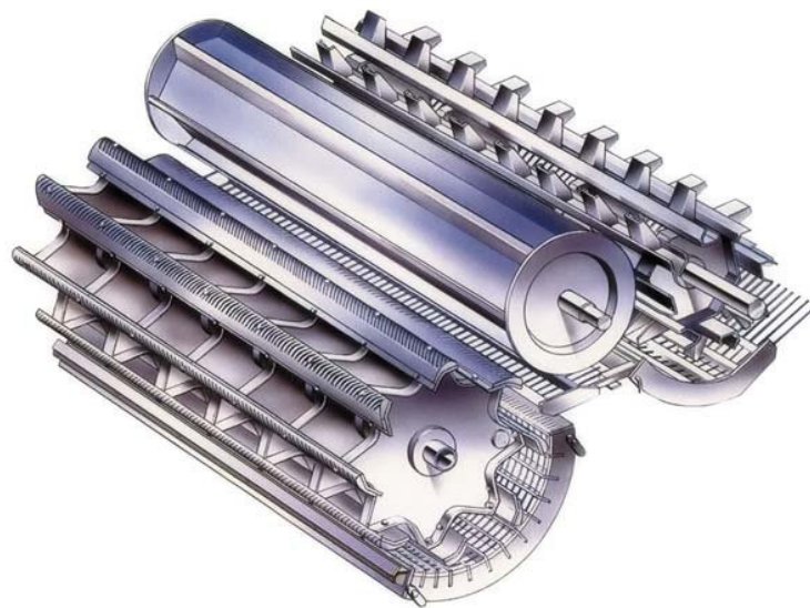
Рисунок 1.8 – Молотильно-сепаруючий пристрій комбайнів MASSEY FERGUSON сериі CEREА
