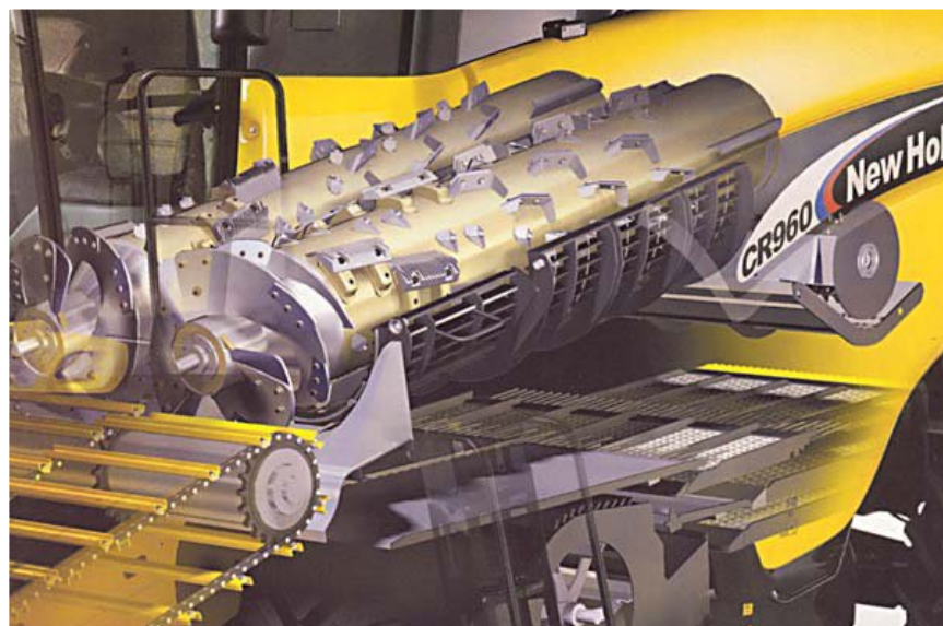
Рисунок 1.5 – Молотильно-сепарирующий пристрій комбайнів NEW HOLLAND серії CR
