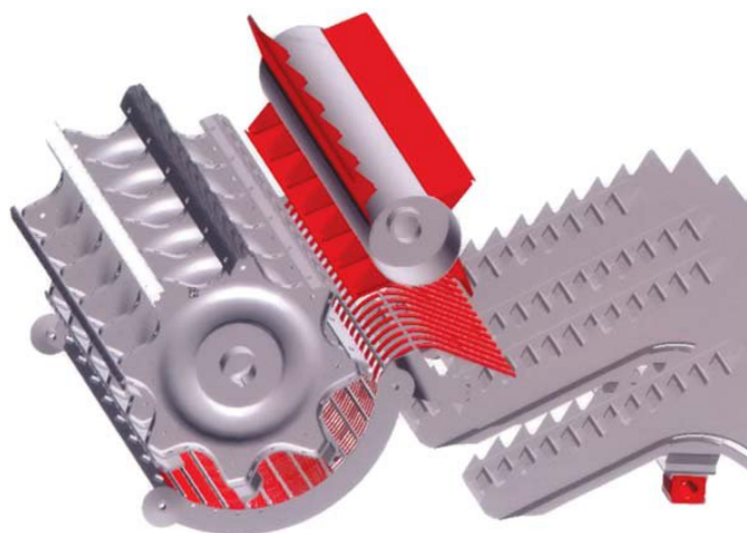
Рисунок 1.3 – Молотильно-сепаруючий пристрій комбайнів MASSEY FERGUSON серії ACTIVA
