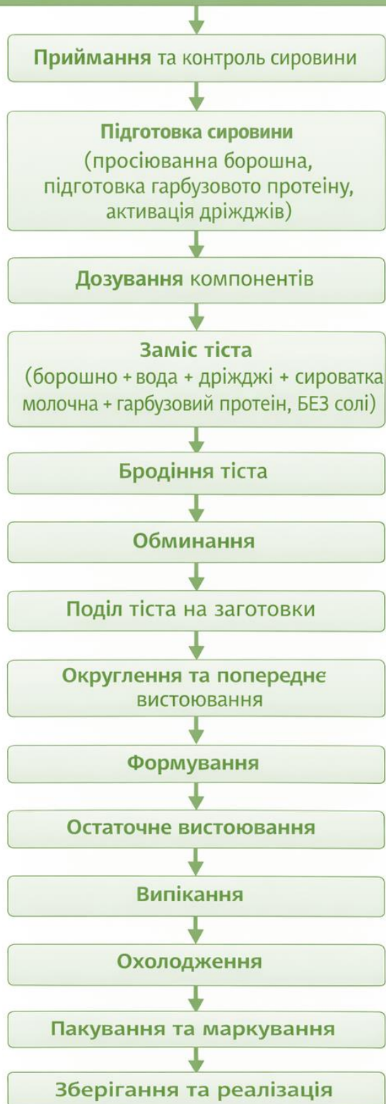
Рисунок 1.5 - Технологічна схема виробництва хліба «Ахлоридний» з гарбузовим протеїном
