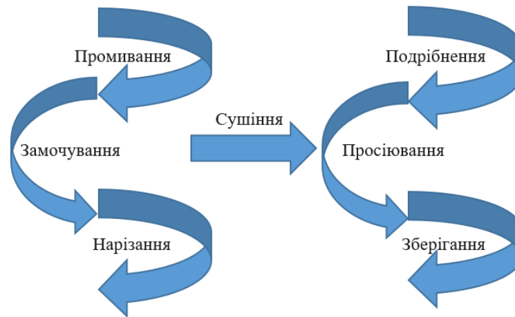
Рисунок 1.2. Етапи попередньої обробки бананового борошна.
