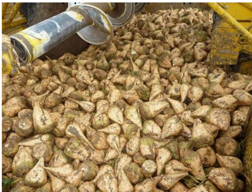
Рисунок 2.8 – Бурякозбиральні комбайни фірми ROPA з розрівнюючим шнеком
