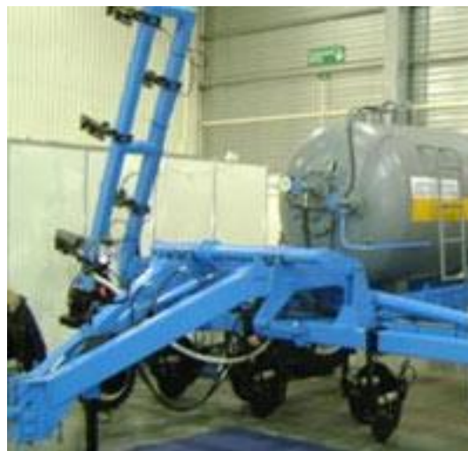
Рисунок 1.2 – Аплікатор для внесення рідких мінеральних добрив ПРД-3500
