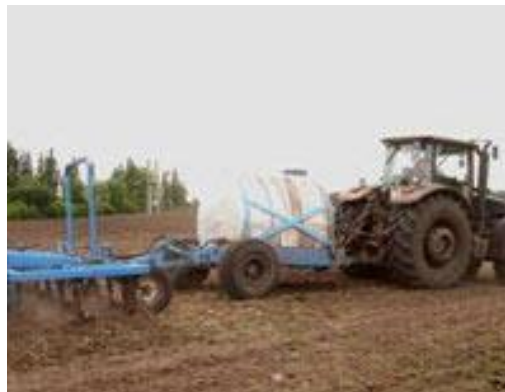
Рисунок 1.3– Підживлювач причіпної серії 5000 для внесення рідких мінеральних добрив
