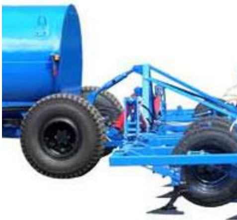
Рисунок 1.1 – Агрегат для внесення аміачної води АВА - 8
