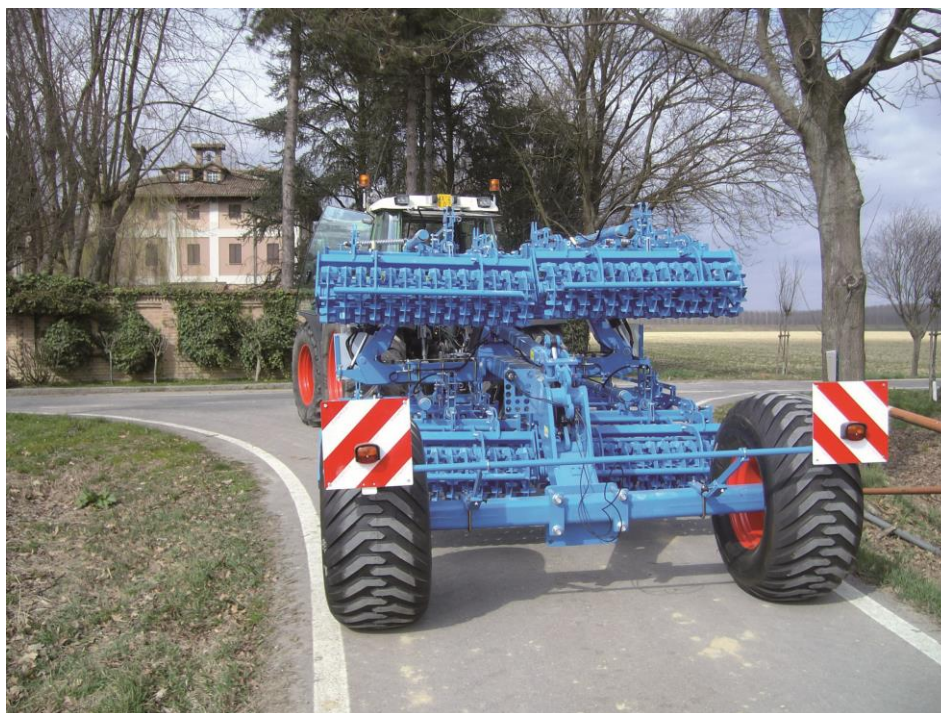
Рисунок 1.5 – Комбінований передпосівний агрегат LEMKEN System-Kompaktor
