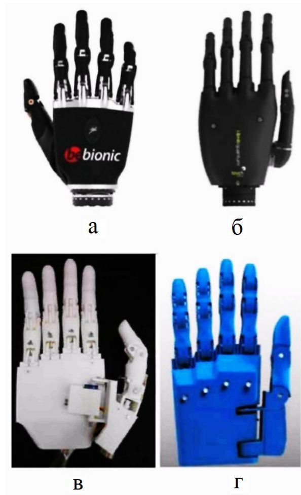
Рис. 1.1. Роботизований протез руки (а) Bebionic, (б) i-Limb, (в) рука Tact та (г) рука Dextrus.
