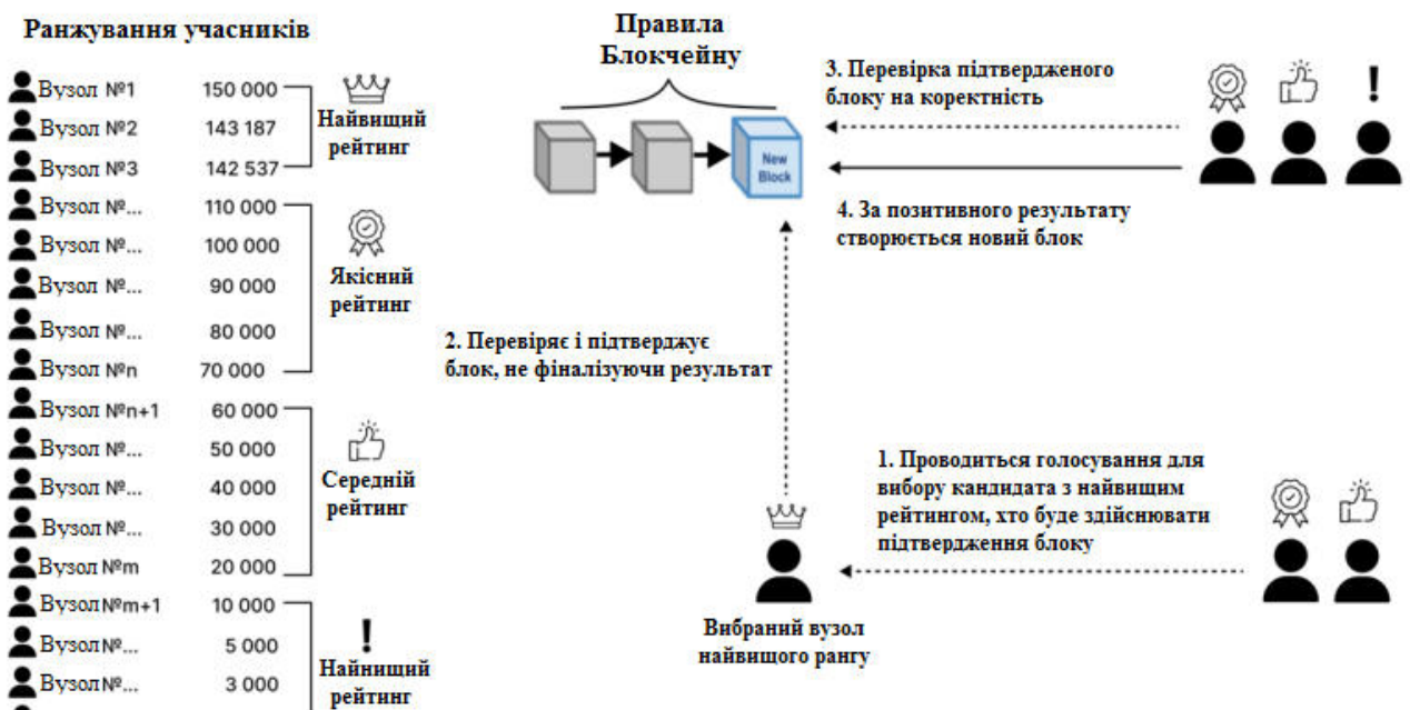
Рисунок 2.8 – Схема роботи алгоритму PoR
