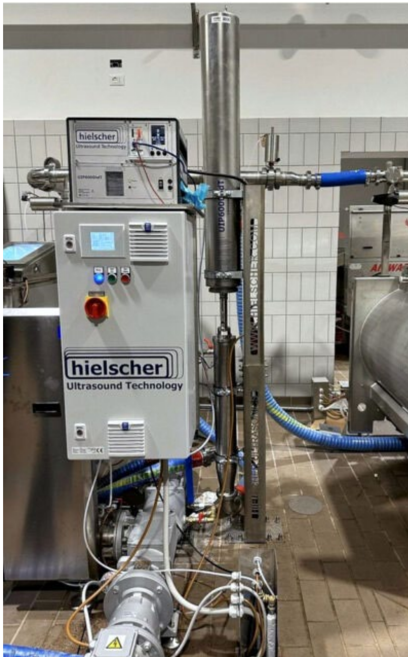
Рис. 1.10. Ультразвуковий апарат Hielscher UIP6000HDT для потокової обробки рідин і рідинних середовищ у промислових масштабах.
