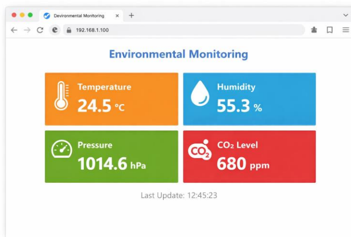
Рисунок 3.3 – Скрін веб інтерфейсу відображення результатів контролю кліматичних параметрів у приміщенні
