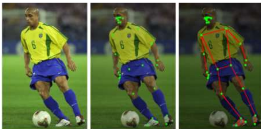
Рисунок 1.3 – Узагальнений принцип роботи алгоритмів оцінки пози людини з формуванням скелетної моделі.
