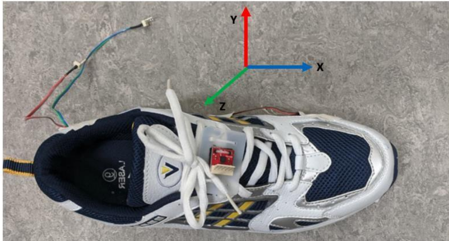
Рис. 2.10. Структура системи з використанням (зверху) акселерометра (ADXL 355), закріпленого на верхній частині взуття, та (знизу) датчиків тиску (FSR 406) [31]
