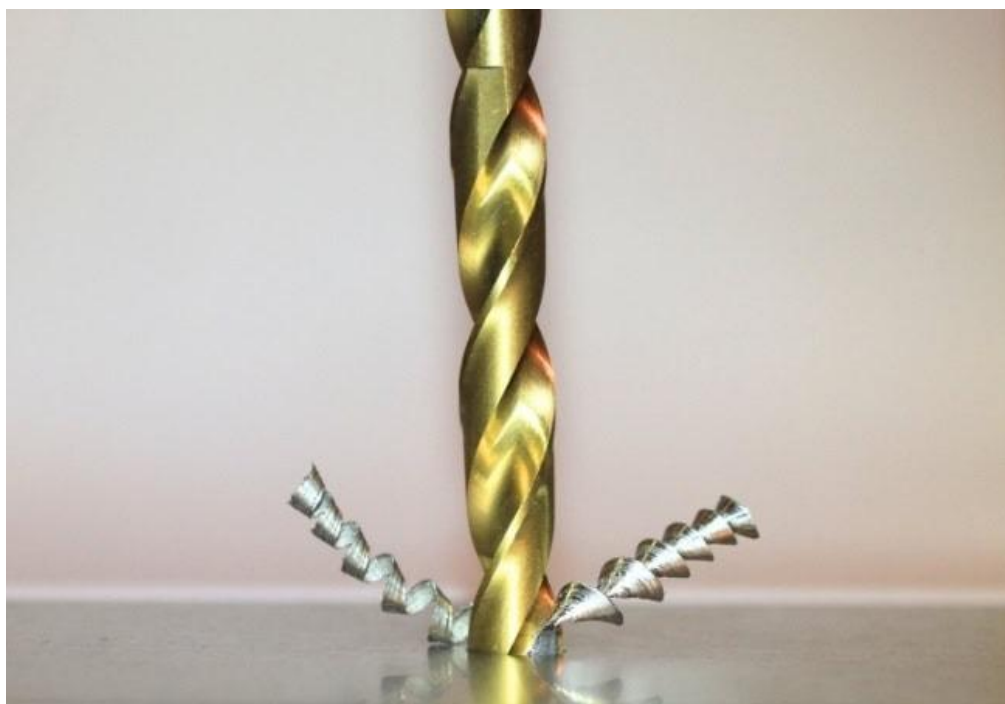
Рис. 1.8 – Відведення стружки при свердлінні
