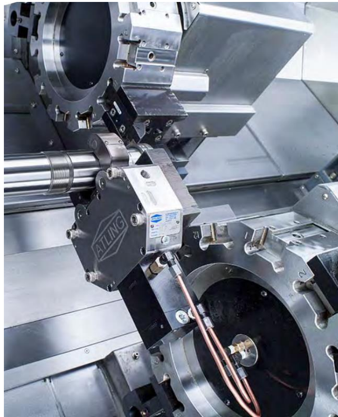
Рисунок 1.3 – Застосування люнету компанії Atling на токарному верстаті з ЧПК [18]
