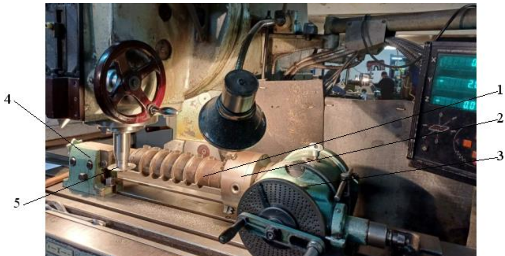
Рисунок 1.7 – Виконання процесу фрезерування пазів на тонкостінних витках гвинтових заготовок, використовуючи вертикально-фрезерний верстат з ЧПК [26]
