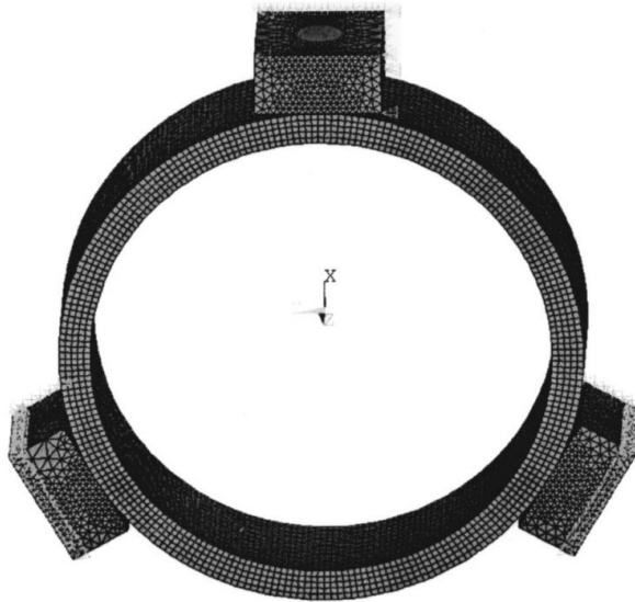
Рисунок 1.5 – Скінченно-елементна модель кільця із затискними елементами [19]
