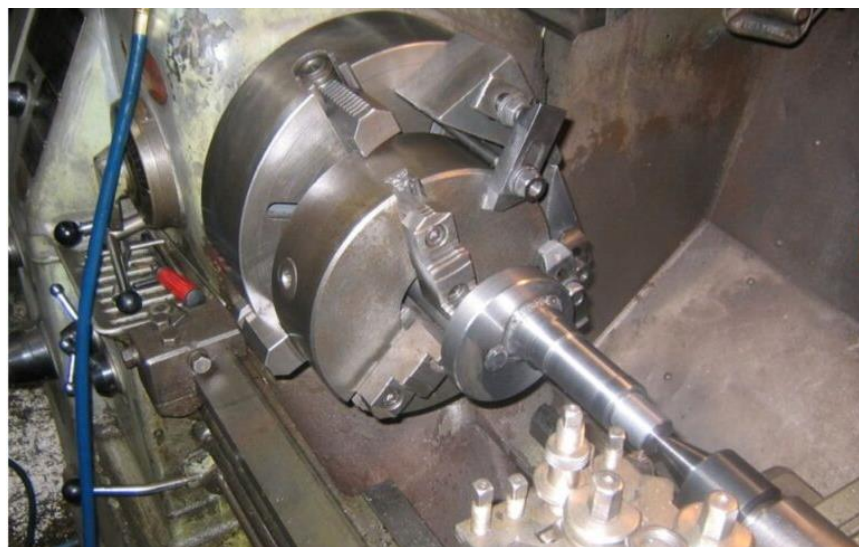
Рисунок 1.3 – Налагодження планшайби із патроном для токарного оброблення ексцентрикових поверхонь [12]
