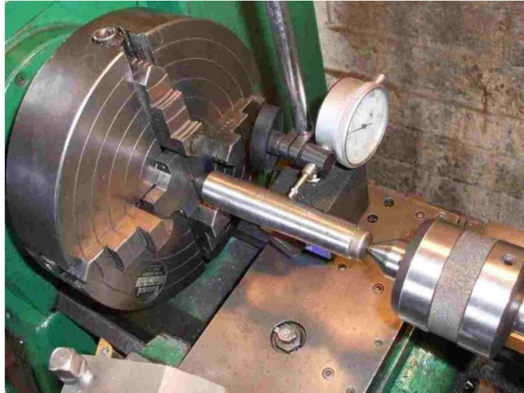
Рисунок 1.2 – Налагодження чотирьохкулачкового патрона для токарного оброблення ексцентрикових поверхонь [12]
