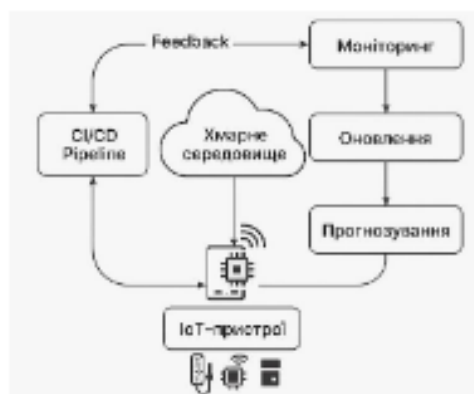
Рис. 1. Узагальнена схема DevOps-процесу для IoT-систем на основі сучасних підходів
