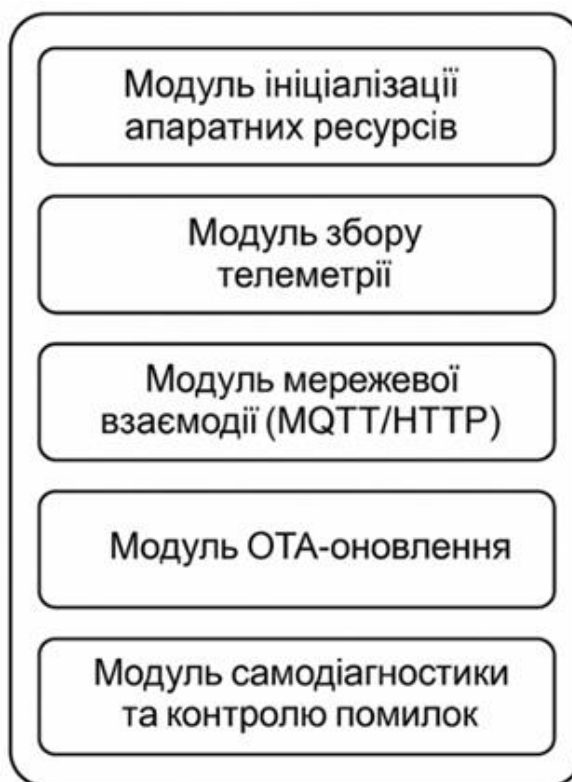
Рис. 3.2. Структурна схема прошивки ESP32
