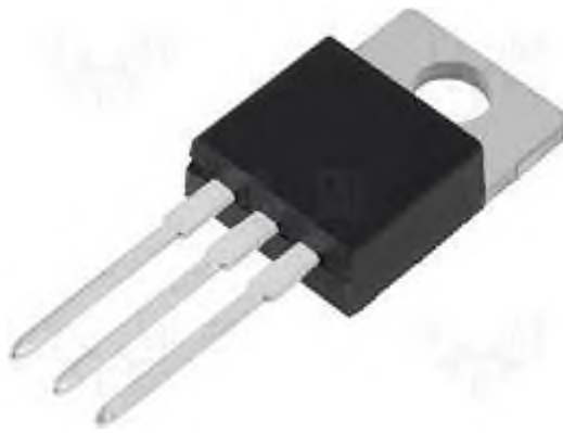
Рисунок 2.13 Мікросхема KP142EH12A - вигляд зовнішній
