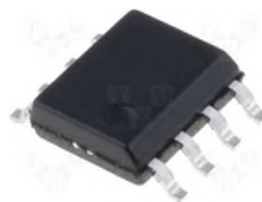
Рисунок 2.6 – Зовнішній вигляд мікросхеми типу AT24C64N-10SI-2.5 виробництва компанії «Atmel»
