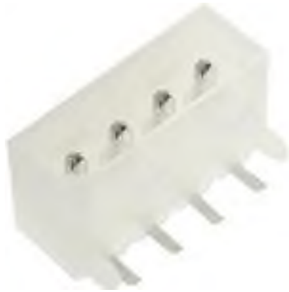
Рисунок 2.21 – Зовнішній вигляд роз'єму типу 5081R виробництва компанії «China»
