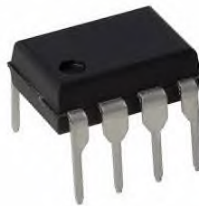
Рисунок 2.7 – Зовнішній вигляд мікросхеми типу DS1307 виробництва компанії «Maxim»
