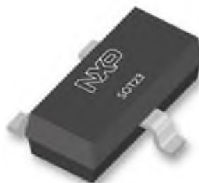
Рисунок 2.18 – Зовнішній вигляд транзистора типу 2N7002 виробництва компанії «Fairchild Semiconductor»
