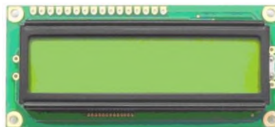
Рисунок 2.12 – Зовнішній вигляд індикатора типу WH1602B-YYK-CTK виробництва компанії «Winstar»
