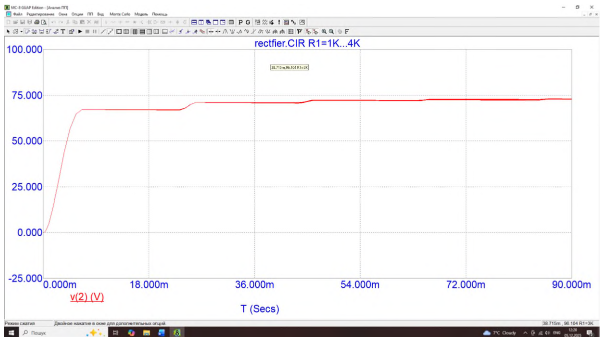
Рисунок 3.8 . Вихідний сигнал при варіації опору конденсатора згладжуючого фільтра (діоди марки GENERIC)
