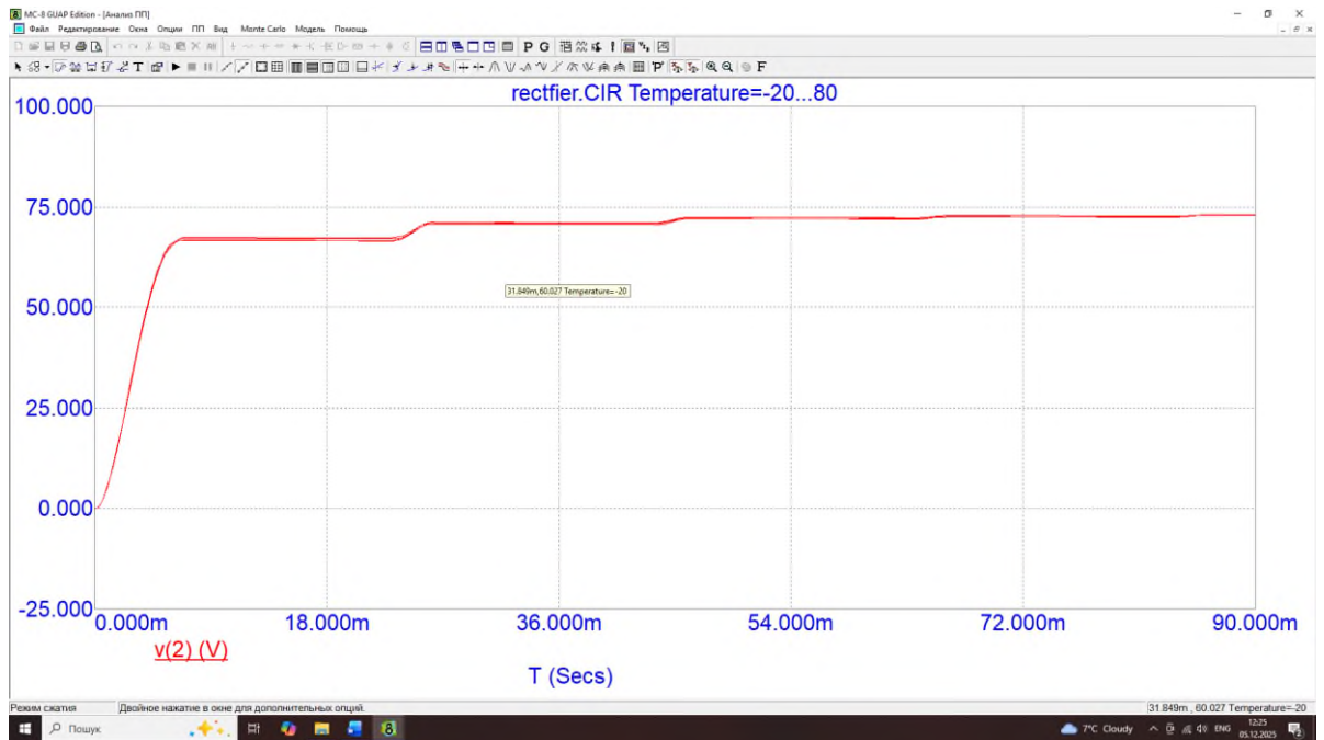
Рисунок 3.9 Вихідний сигнал при варіації температури середовища (діоди марки GENERIC)
