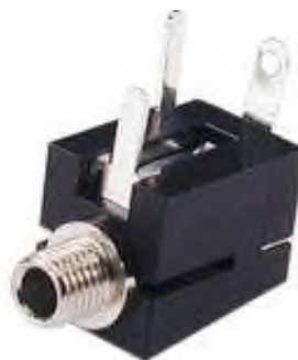
Рисунок 2.14 – Зовнішній вигляд роз'єму типу РУ-501N виробник фірми «DCI»
