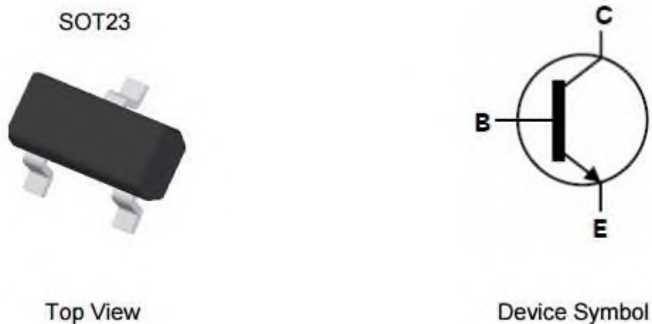
Рисунок 4.9 – Визначення транзистора біполярного BC817
