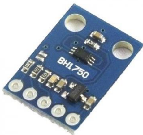
Рисунок 2.3 – Давач освітленості GY-302
